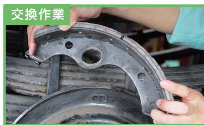
ブレーキ・シューを車両から取り外し中
