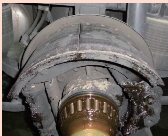
ブレーキ・ライニングの焼け 熱によるハブ・グリースの流出
