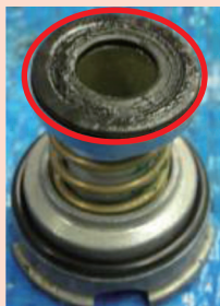
ゴム部品の膨張・変形
