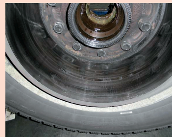
ブレーキ・ドラムの摩耗及び焼け
