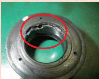
バルブの損傷
